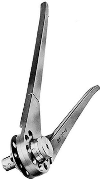
Diese einfache Schneidzange zum manuellen Abschneiden von Nieten ist mit einer Mikrometereinstellung ausgerüstet und ermöglicht das genaue Abschneiden aller Aluminiumnieten mit einem  $\varnothing$  von 1,6 - 6 mm auf die gewünschte Länge.
