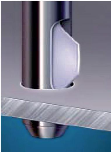
1. Das rotierende Werkzeug wird in die vorhandene Bohrung eingeführt, die ausgeführte Klinge/Schneide entgratet den oberen Bohrungsrand. Durch den Druck der Vorwärtsbewegung wird die Klinge/Schneide in die vorhandene Nut im Werkzeugträger gedrückt.
