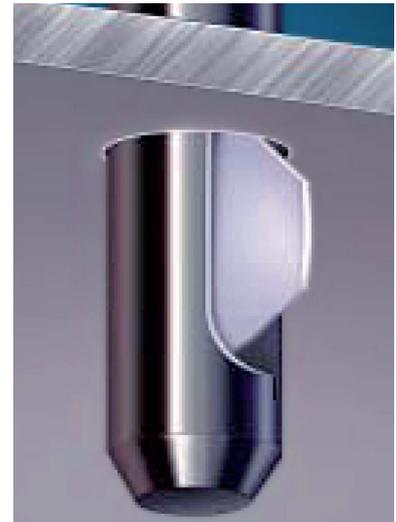
3. Ist das Werkzeug entsprechend durch die Bohrung geführt, verlässt die Klinge/Schneide die Nut im Werkzeugträger. Wird nun der Vorschub umgekehrt, wird der Grat am unteren Bohrungsrand entfernt. Nach Entfernung des Grates wird die Klinge/Schneide wieder eingedrückt, das Werkzeug kann im Eilgang aus der Bohrung gefahren und mit der nächsten Bohrung fortgefahren werden.
