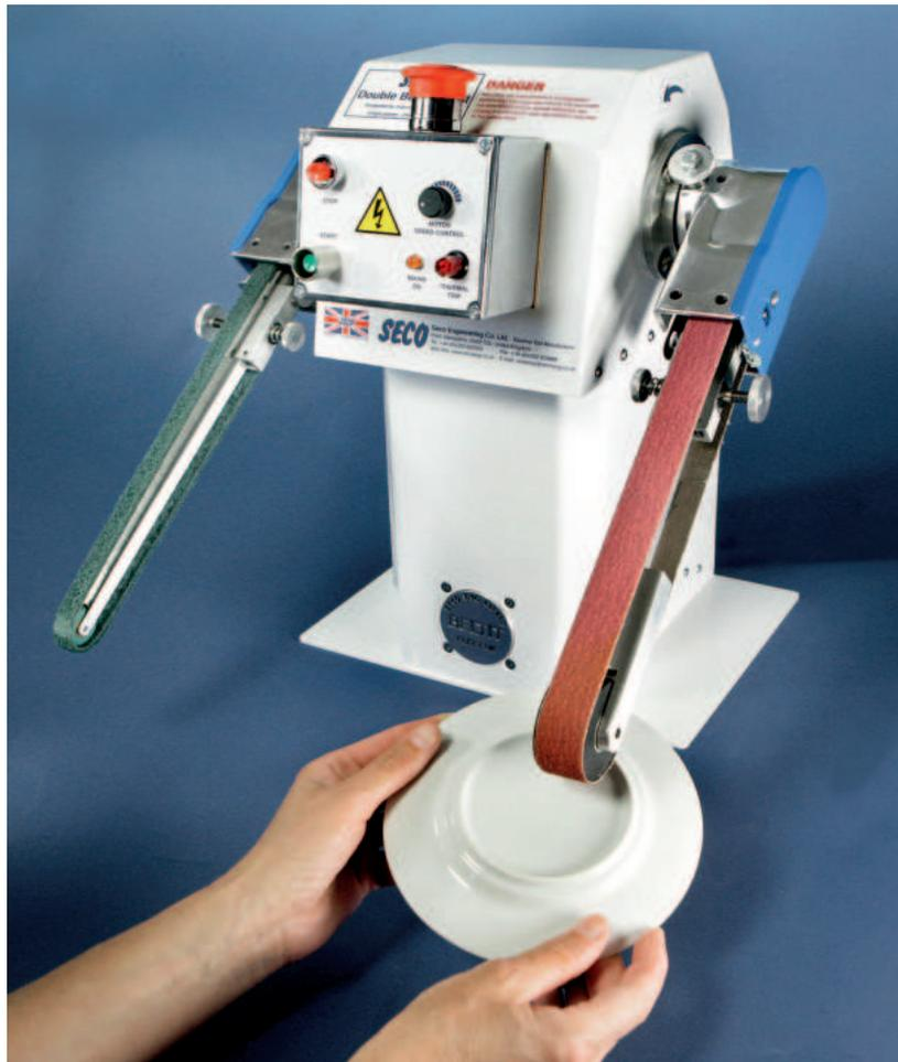
Entfernen von Ungleichmäßigkeiten an Keramiktellern, wie z.B. Entfernen von Brenn- und Beflockungsrückständen sowie Verzierungsfehler
